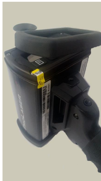
Slika 9. ProLaser 4 - Prikaz smještaja natpisne pločice, ovjerne naljepnice te zaštitne naljepnice na vijku
