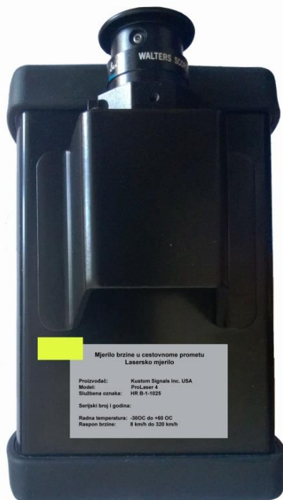
Slika 9. ProLaser 4 - Prikaz smještaja natpisne pločice, ovjerne naljepnice te zaštitne naljepnice na vijku
